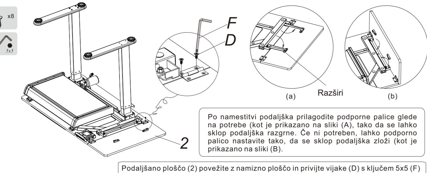
Po namestitvi podaljška prilagodite podporne palice glede na potrebe (kot je prikazano na sliki (A), tako da se lahko sklop podaljška razgrne. Če ni potreben, lahko podporno palico nastavite tako, da se sklop podaljška zloži (kot je prikazano na sliki (B)).
